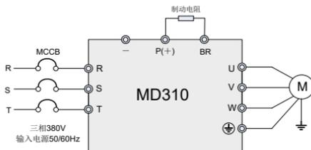
图 3-5 三相 380V 主回路接线示意图（18.5kW 及以下）
