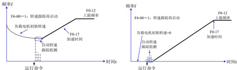
图 4-10 速度跟踪再启动方式
