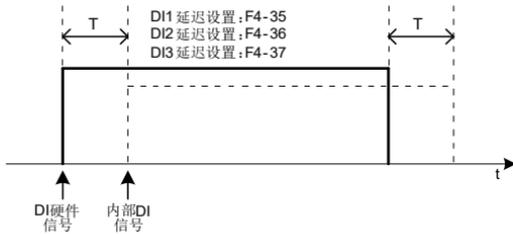
图 4-28 端口信号延迟功能
