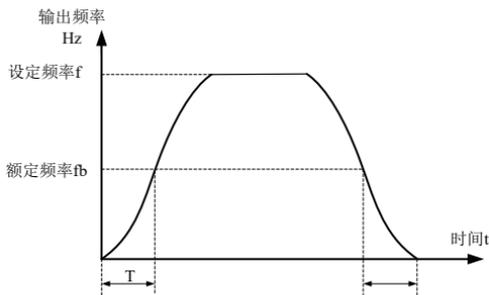
图 6-18 动态 S 曲线加减速示意图
