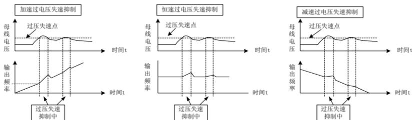
图 6-11 过压失速动作示意图
