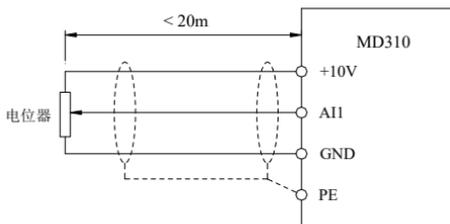
图 3-14 模拟量输入端子接线示意图
