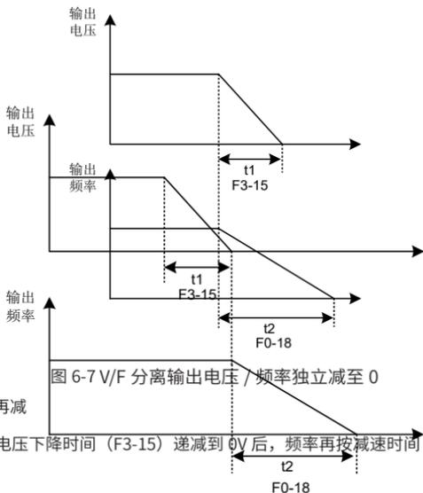
V/F 分离输出电压先按电压下降时间 (F3-15) 递减到 0V 后, 频率再按减速时间 (F0-18) 递减到 0Hz。
