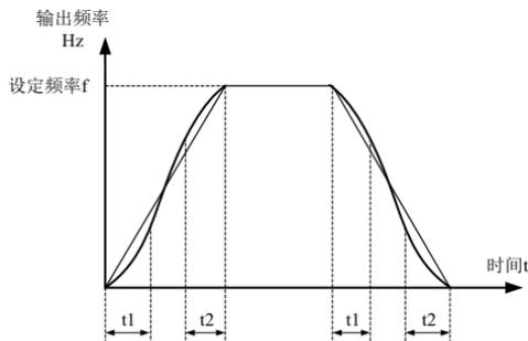
图 6-17 静态 S 曲线加减速示意图
