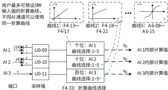
图 4-29 电压或电流值对应实际给定或反馈物理量关系设定
