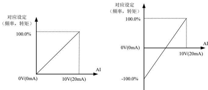
图 6-16 模拟给定与设定量的对应关系
