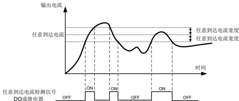
图 6-29 任意到达电流检测示意图
