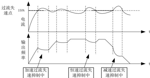
图 6-9 过流失速动作示意图
