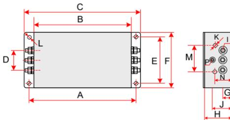
图 7-3 扼流滤波器 DL-25EBK5/DL-35EBK5/ DL-50EBK5 尺寸图
