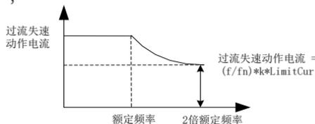
图 6-10 倍速过流失速动作示意图
