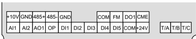
图 3-13 控制回路端子布置图
