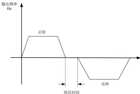
图 6-21 正反转死区时间示意图
