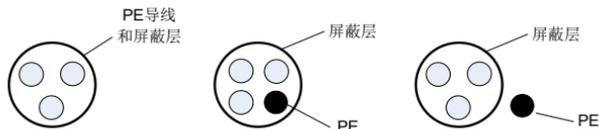
图 7-4 屏蔽电缆侧面示意图
