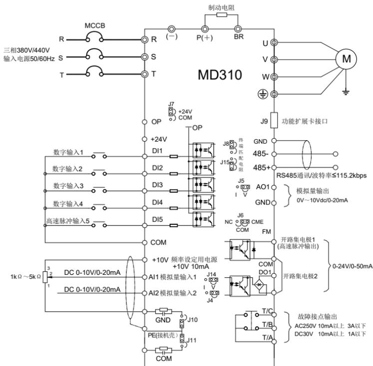
图 3-19 MD310 系列变频器接线示意图
