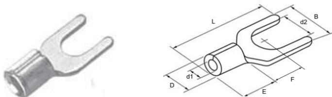
图 3-12 TNS 系列叉形线耳外观及尺寸图（【注】）
