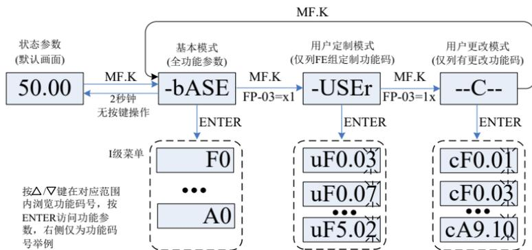
图 4-5 使用 MF.K 按键切换功能码显示模式
