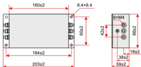
图 7-2 竖力滤波器 DL-5EBK5 尺寸图 (单位: mm)
