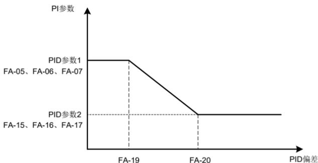
图 6-33 PID 参数切换
