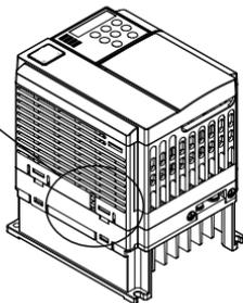
图 7-8 MD310T0.4B、MD310T0.7B、MD310T1.5B、MD310T2.2B、MD310T3.7B、MD310T5.5B 安规电容跳线位置及断开方法
