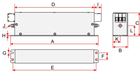
图 7-1 FN3258 系列 7-42A 滤波器尺寸图 (单位: mm)
