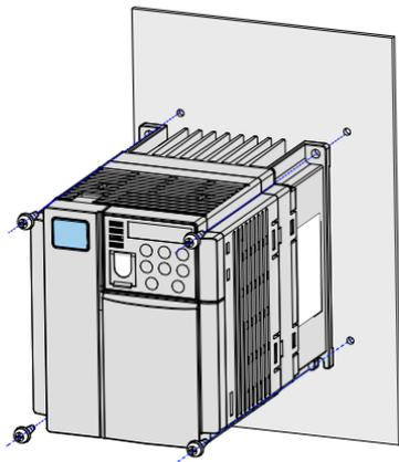
图 3-3 塑胶结构壁挂式安装示意图
