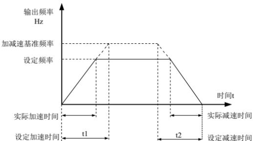
图 6-2 加减速时间示意图
