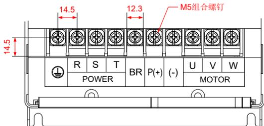
图 3-9 15kW ~ 18.5kW 功率等级的接线端子尺寸图
