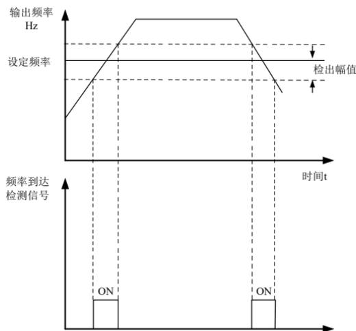
图 6-23 频率到达检出幅值示意图
