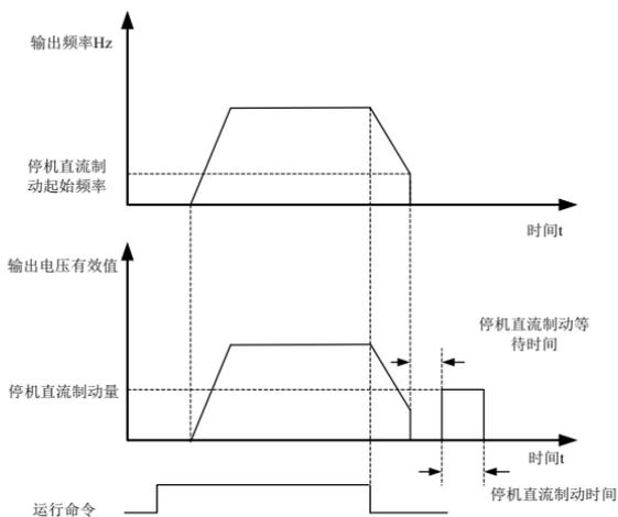
图 6-19 停机直流制动示意图
