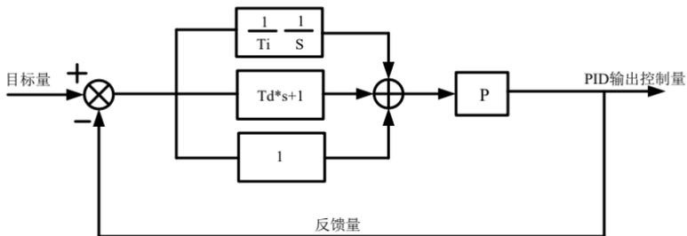
图 6-32 过程 PID 原理框图
