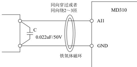
图 3-15 模拟量输入端子处理接线图
