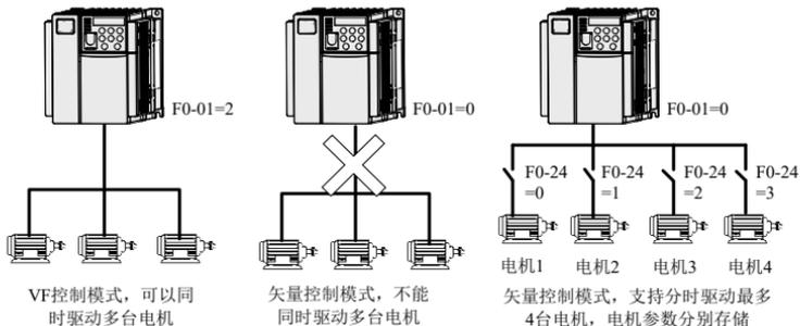
图 4-27 多组电机参数的设置和切换
