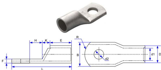
图 3-10 GTNR 系列圆型线耳外观及尺寸图 (推荐)
