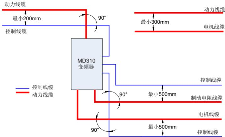
图 7-7 电缆布线图
