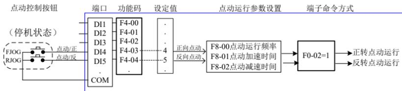
图 4-16 通过 DI 端口点动运行
