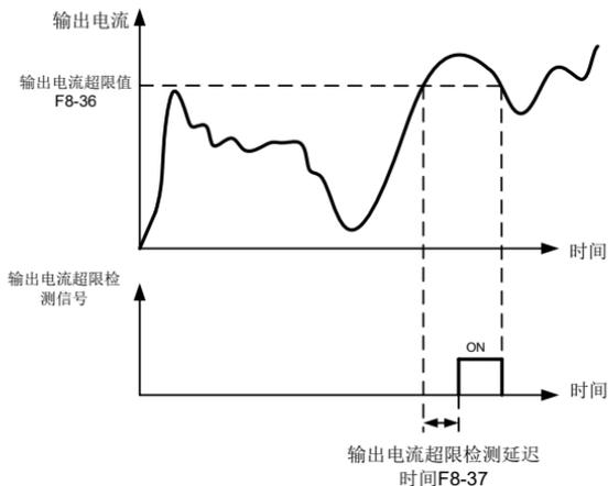
图 6-28 输出电流超限检测示意图
