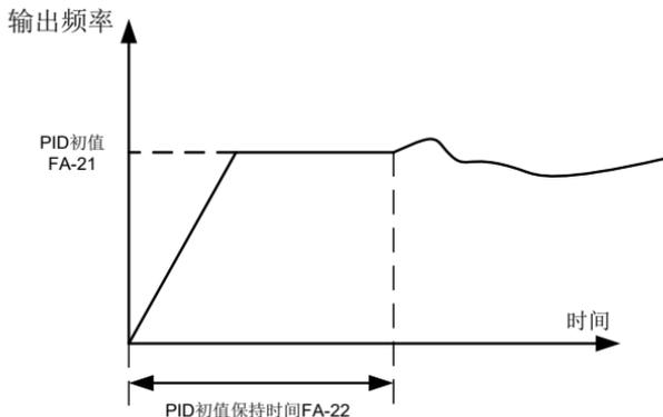
图 6-34 PID 初值功能示意图
