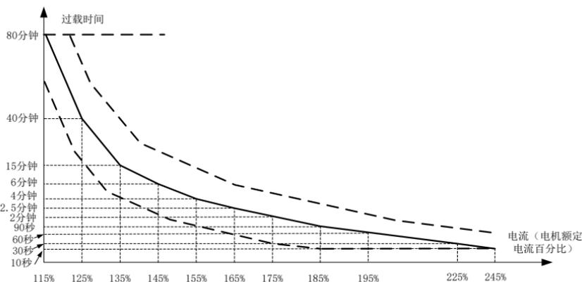
图 6-30 电机过载保护反时限曲线示意图
