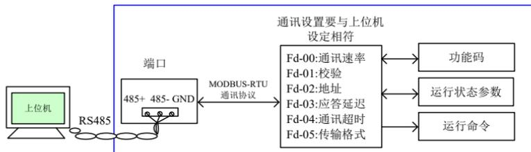
图 4-31 变频器串行通讯的使用
