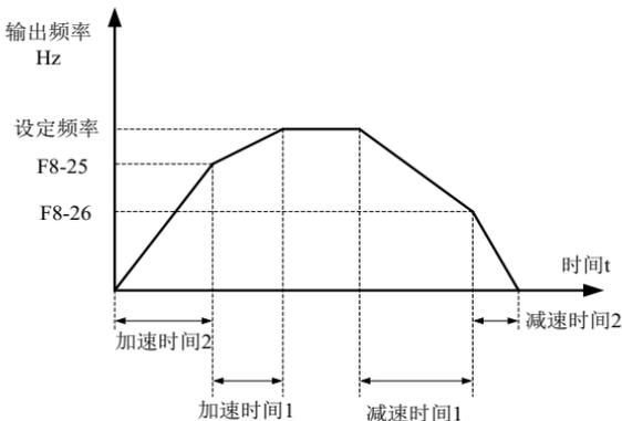
图 6-25 加减速时间切换示意图
