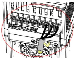
图 7-6 屏蔽电缆接地示意图
