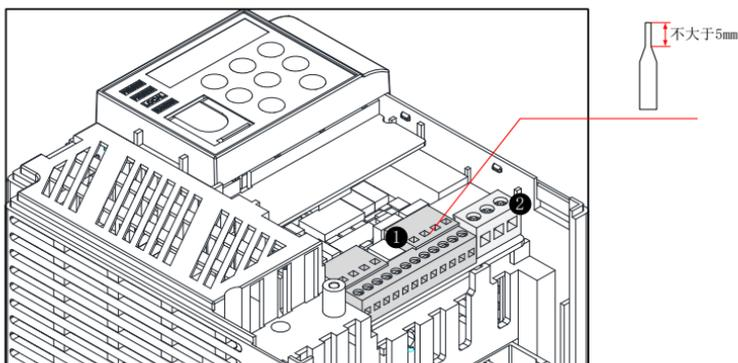
图 3-21 控制线管状端子要求
