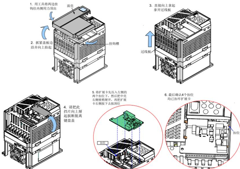
图 B-2 MD310-IO1 扩展卡安装步骤
