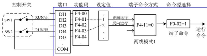
图 4-6 端子起停控制方式举例
