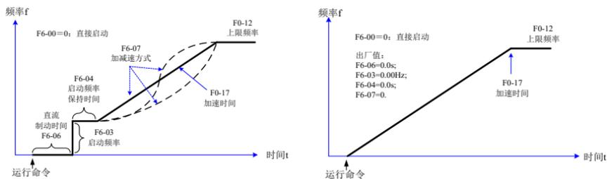
图 4-9 直接启动方式
