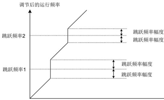
图 6-24 加减速过程中跳跃频率有效示意图
