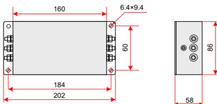
图 7-3 竖力滤波器 DL-10EBK5/ DL-16EBK5 尺寸图 (单位: mm)
