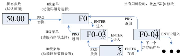
图 4-2 三级菜单操作流程图
