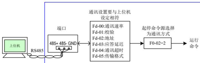
图 4-8 通讯起停控制方式举例
