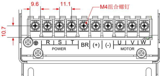
图 3-7 3.7kW ~ 5.5kW 功率等级的接线端子尺寸图
