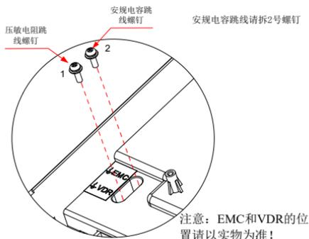
图 7-9 MD310T7.5B、MD310T11B、MD310T15B、MD310T18.5B 安规电容跳线位置及断开方法
