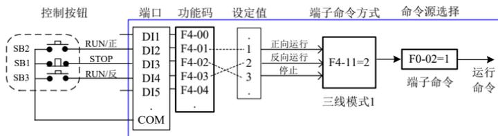
图 4-7 端子起停控制方式举例
