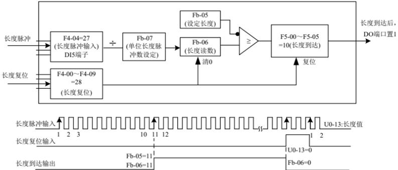
图 4-24 定长控制模式功能码设置
